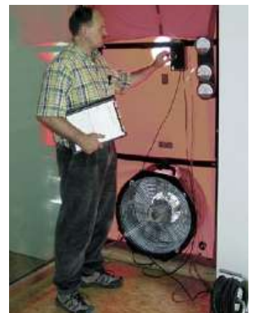
Qualitätskontrolle durch einen Luftdichtheitstest (Blower-Door-Test)
